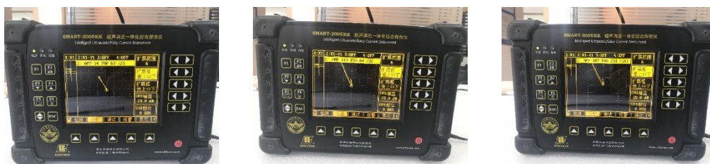
a) 深 0.5 mm 缺陷信号 b) 深 1.0 mm 缺陷信号 c) 深 2.0 mm 缺陷信号
